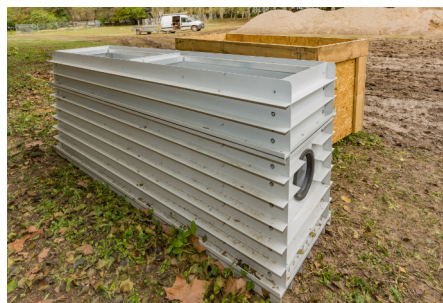
Canal de mesure débitimétrique
